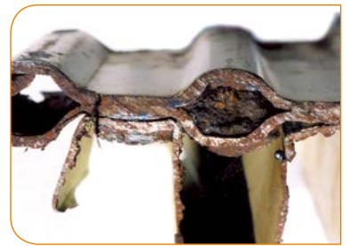
Zugesetzte Heizkörper aufgrund von Ablagerungen
