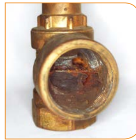
Magnetitschlamm in Rohren und Ventilen
